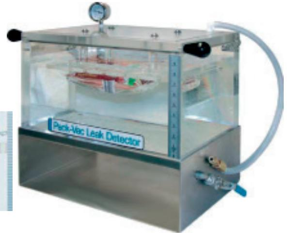
La Cámara Pack-Vac detecta de las más pequeñas fugas aun sin un gas trazador. Requiere de suministro de aire seco y limpio de 80-110 Psi, la muestra se coloca dentro de la cámara, al cerrar la tapa la muestra se mantiene sumergida en el agua y se acciona el suministro de aire, generando el vacío dentro de la cámara y aumentando la presión dentro del empaque.
